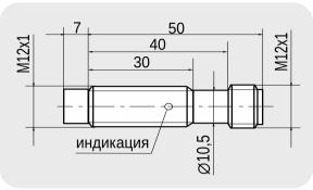
Индуктивные бесконтактные выключатели для кранов, клапанов, поворотных задвижек ISB КС1Р
