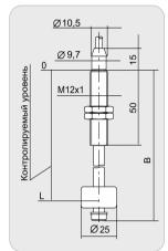
ке, вызывая поочередное замыкание магниточувствительных герконовых контактов, расположенных внутри направляющей трубки.
